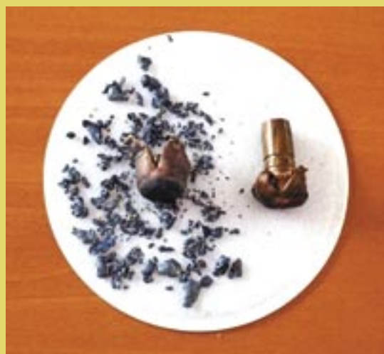
Rys.1. Porównanie pocisku ołowianego (z lewej) i nieołowianego (z prawej) po wystrzeleniu w takich samych warunkach. Na zdjęciu widoczna jest wyraźna fragmentacja pocisku ołowianego. Źródło: www.nps.gov
