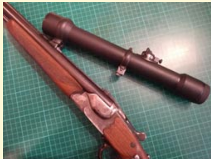
Montaż hakowy ze względu na sposób zakładania zalecany jest jedynie do lunet o niewielkiej średnicy obiektywu.
