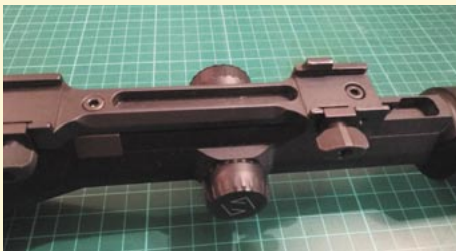
Luneta z szyną wewnętrzną Zeissa zamontowana na montażu typu jaskółczy ogon.
