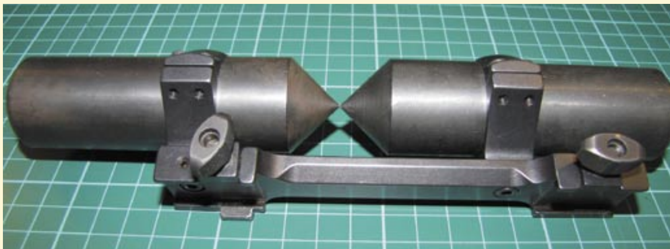
Prawidłowo wykonany montaż jednoczęściowy powinien być współosiowy.
